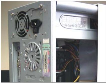
Una fuente de alimentación ATX dañada puede ocasionarnos multitud de quebraderos de cabeza, como apagados aleatorios o dificultades durante el arranque.
