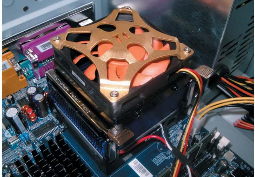
corriente lo conectamos a la tarjeta de alimentación PCI y el amarillo a los *pin*s del conector de la placa que utilizamos para enchufar un ventilador de CPU tradicional (CPU FAN).
