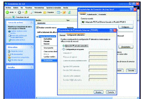
Windows XP permite determinar dos configuraciones diferentes para el protocolo TCP/IP, algo que agradecerán muchos usuarios móviles.
