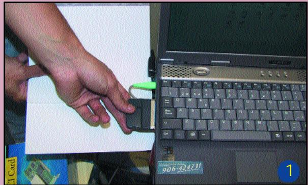
El primer paso a dar es la instalación de la tarjeta de red inalámbrica en un PC. Para ello, basta con «pincharla» en una ranura PCMCIA y,
