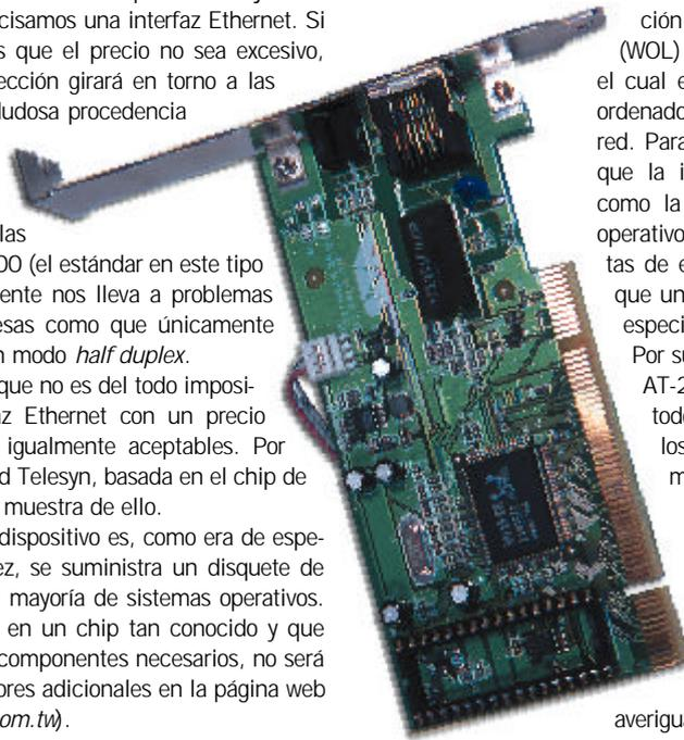
Aunque se trata de una función poco utilizada, *Wake On Lan* (WOL) define un método mediante el cual es posible encender nuestro ordenador a través de la tarjeta de red. Para que funcione es necesario que la interfaz esté preparada, así como la placa madre y el sistema operativo. Es fácil reconocer las tarjetas de este tipo gracias a un cable que une la tarjeta con un conector especial situado en la placa base.
