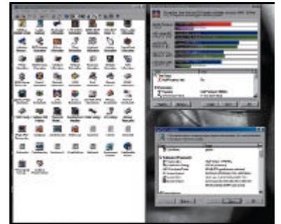
Mediante aplicaciones como SiSoft Sandra es posible detectar los componentes de nuestra máquina sin tener que recurrir al destornillador.
