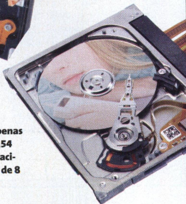
Momentus 5400.3: HD SATA de 2,5 polegadas (para notebooks) e 160 GB. A primeira HD "perpendicular" da Seagate
