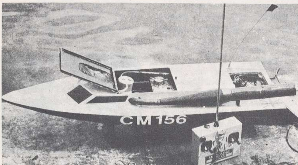
Τό CM156 είναι ένα άγωνιστικό σκάφος ταχύτητας τής κατηγορίας F1-V15. Ό μαύρος σωλήνας είναι ή έξάτμιση που ένδεικνυται για τέτοιου είδους σκάφη.
