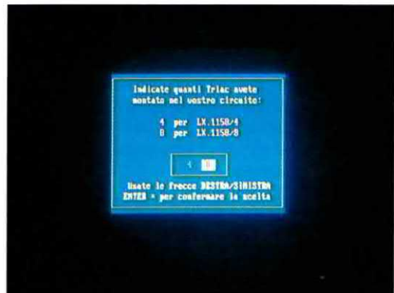
Fig.7 Per ogni programma il computer vi chiederà quanti Triac sono presenti nella vostra scheda LX.1158, cioè se 4 o 8.
