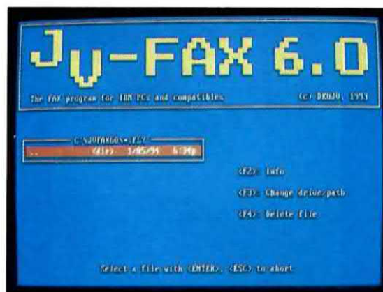
Fig.24 Se non avete memorizzato nessuna immagine, non apparirà nessun file (vedi foto), mentre se avete delle immagini memorizzate apparirà il file D2____.FLL. Posto il cursore su questo file premete il tasto Enter.
