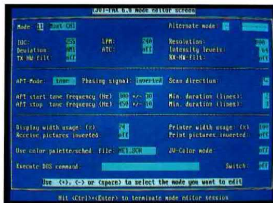
Fig.5 Se dal menu di fig.3 premete per errore il tasto M comparirà questo quadro. Qui non dovrete variare nessun parametro, ma soltanto uscire pigiando Ctrl + Enter.
