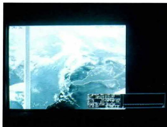
Fig.11 Se quando premete il tasto F (vedi fig.3) il satellite ha già inviato la nota di Start, dovrete attendere la successiva immagine, sempre che non premiate il tasto A , ma in questo modo l'immagine apparirà fuori sincronismo ed in bianco/nero anziché a colori.
