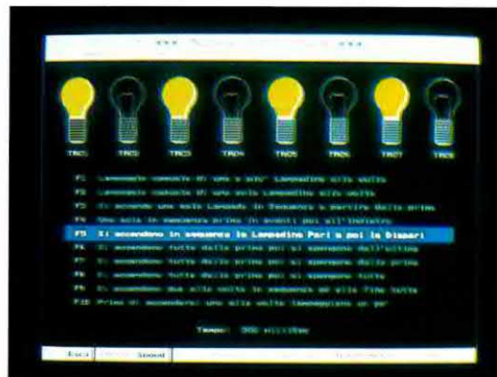
Fig.15 Se avete scelto 8 Triac, appariranno sul monitor otto lampade. Queste lampade si accenderanno anche se avrete collegato al computer la sola interfaccia LX.1127.
