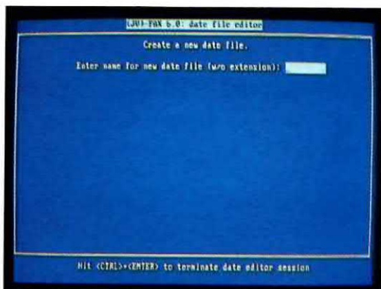
Fig.25 Potrete ricevere in automatico anche i Polari (ma non per l'animazione) se dal menu di fig.3 premerete il tasto E poi F2. Nel riquadro scrivete POLAR001 poi Enter.
