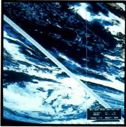
Fig.6 Se l'immagine captata risulta inclinata premete A poi la barra (/) ed in questo modo apparirà una sottile riga verticale che andrà posizionata come spiegato in fig.7.
