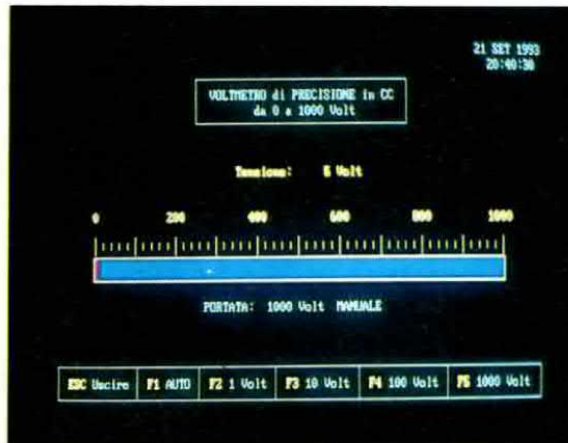
Fig.4 Tenendo i puntali "cortocircuitati" la barra centrale risulterà tutta di colore Blu. Applicando una tensione continua questa barra diventerà di colore Rosso (vedi fig.5).
