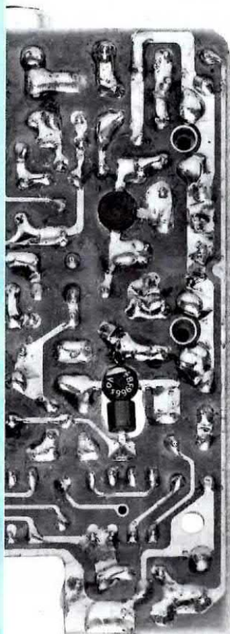
Fig.9 Quando collegherete sulla parte sottostante del circuito stampato il mosfet BF.966/S, dovrete fare molta attenzione a non invertire i suoi piedini. Il terminale più lungo è il Drain, quello opposto è il G1. Per gli altri due terminali G2 ed S di identica lunghezza, solo il terminale S ha vicino al corpo una piccola sporgenza.
