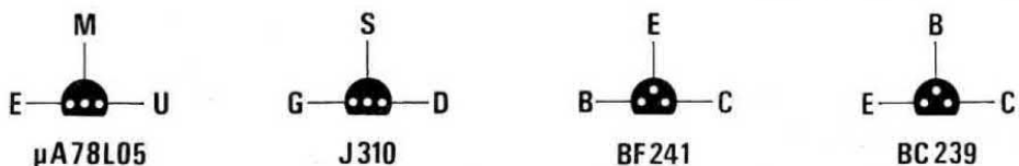
Fig.12 Connessioni dell'integrato IC4 (µA.78L05) del fet J.310 e dei due transistor BF.241 e BC.239 viste da sotto, cioè dal lato in cui i terminali fuoriescono dal loro corpo.
