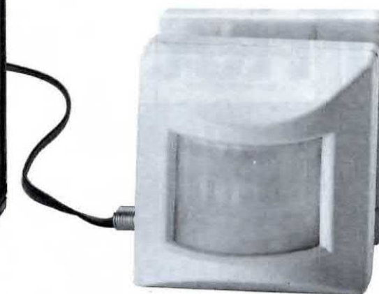
Fig.1 Collocando il sensore ad un'altezza di 2 metri circa dal suolo si riesce a coprire una distanza massima di 10 metri. Aumentando l'altezza si può guadagnare 1 metro di più al massimo. Si notino i tre angoli di radiazione prodotti dalla lente di Fresnell.
