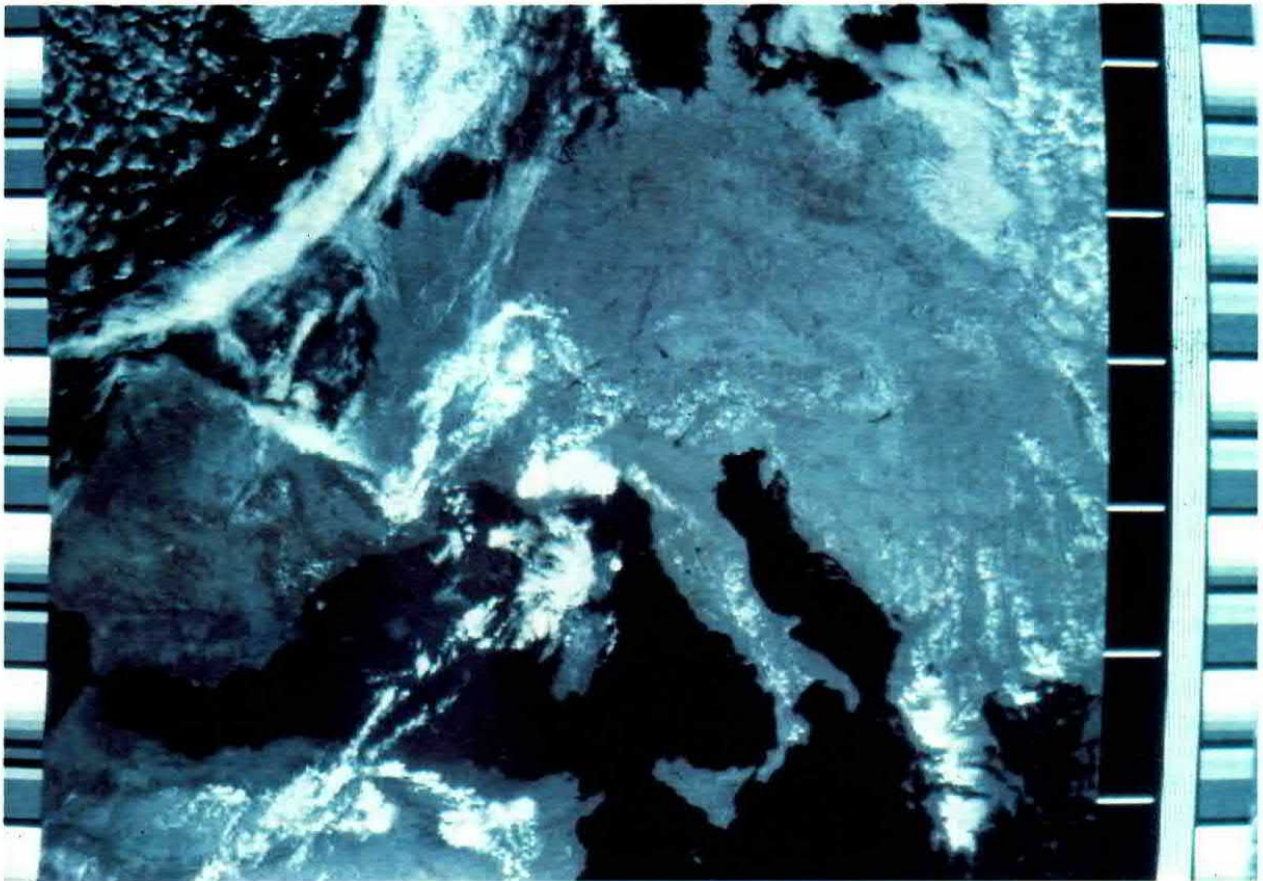
Fig.2 Usando la tecnica DSP si possono realizzare interfacce per alta definizione molto più semplici, che non richiedono nessuna taratura. Questa immagine, che occupa circa 0,20 Megabyte se rilevata con una normale interfaccia, occupa oltre 1 Megabyte con la tecnica DSP. Questi "byte" in più memorizzati, fanno capire quale elevata definizione si riesce ad ottenere.
