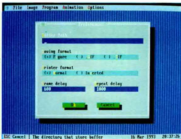
Fig.22 Premendo Alt O e P potrete cambiare la velocità "Frame Delay" e la pausa "Repeat Delay" tra due sequenze.
