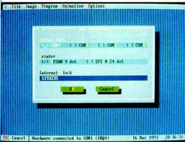
Fig.6 Per correggere la frequenza dell'Internal Clock, dovrete premere il tasto Alt O poi H (leggere articolo).
