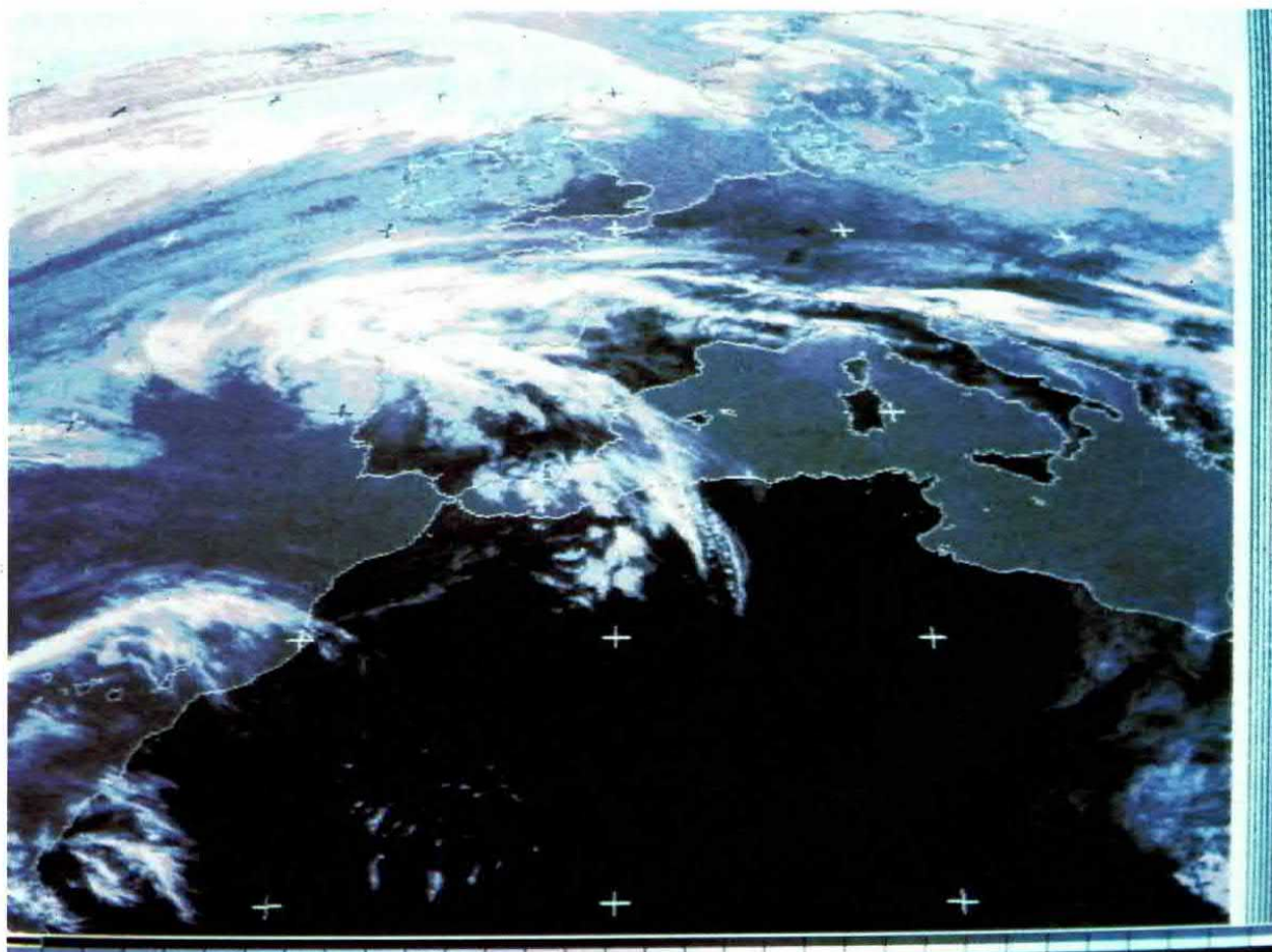
Fig.8 Per poter valutare le caratteristiche di una interfaccia è sufficiente controllare le "crocette" dei meridiani e paralleli presenti sull'immagine. Le interfacce che mancano di definizione non riescono a completare queste crocette, quindi faranno apparire delle L oppure delle T.
