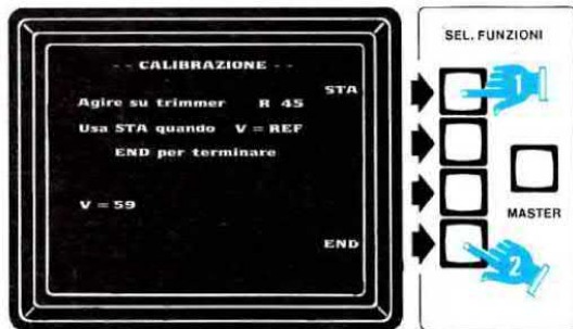
Fig.24 A questo punto ruotate il trimmer R45 fino a far apparire di fianco a V = lo stesso numero riportato sull'etichetta del Generatore di Rumore. Quindi pigiate STA oppure END se il numero corrisponde.
