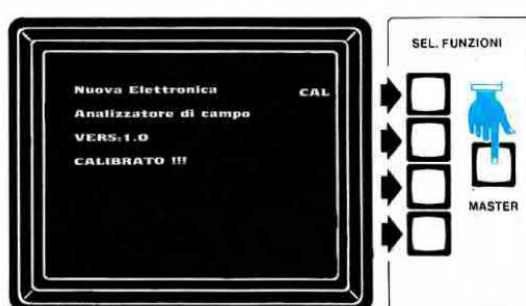
Fig.29 In seguito, tutte le volte che accenderete l'Analizzatore, apparirà la scritta CALIBRATO, poi dopo 10 secondi il Tuner si commuterà sempre sulla banda UHF. Per il tasto Master vedere la fig.30.
