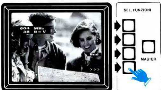
Fig.33 Pigiando Bnd ci sintonizzeremo sulle altre Bande. Pigiando il tasto >>> apparirà la barra del Vu-Meter ( vedi fig.34 ).
