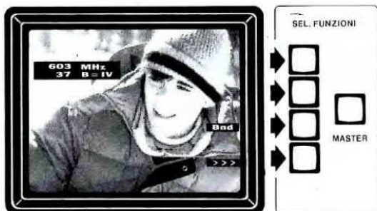
Fig.32 Ruotando la manopola della sintonia appariranno le immagini delle altre emittenti con la frequenza, il Canale e la Banda.
