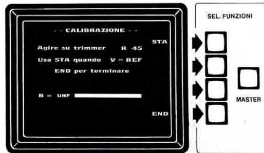
Fig.27 Per ultimo apparirà la scritta B = UHF ( banda 4° e 5° ) e nuovamente vedremo una barra bianca che, partendo da sinistra, scorrerà verso destra per memorizzare la linearità del Tuner in UHF.
