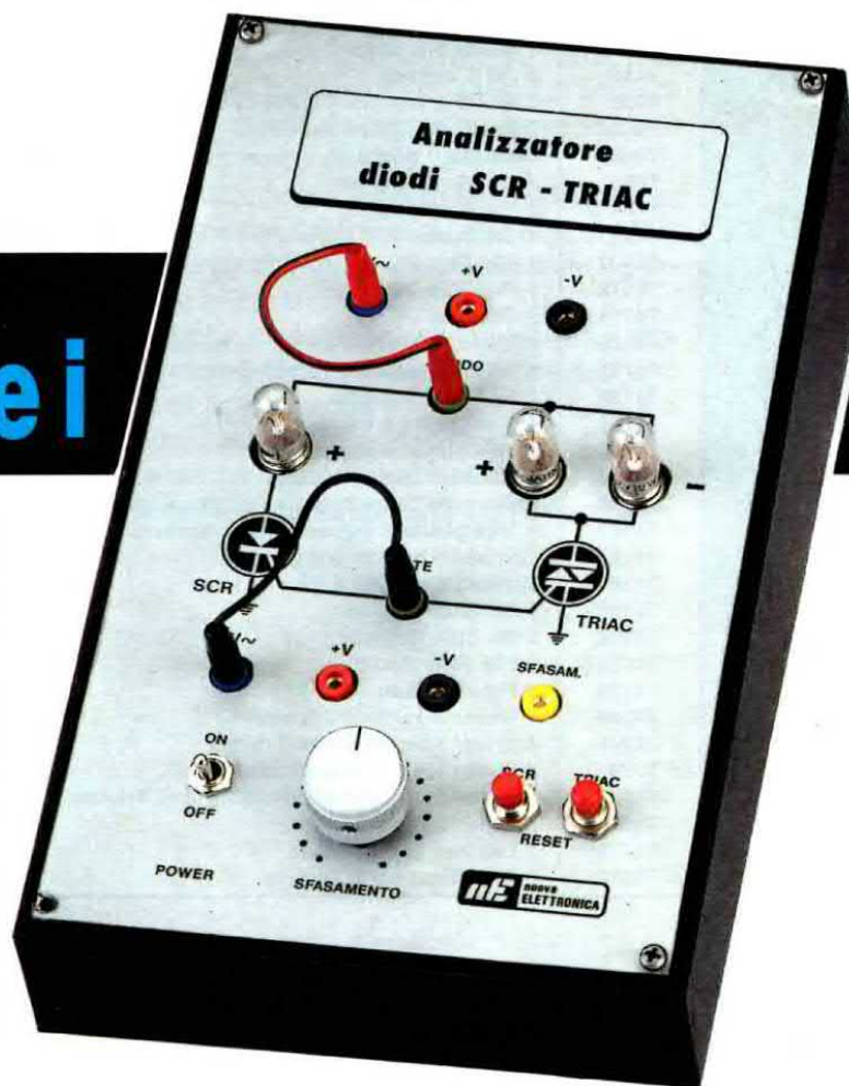
Fig.1 Questo analizzatore vi permetterà di verificare il comportamento di un diodo SCR o TRIAC alimentando il suo Anodo con una tensione continua o alternata ed eccitando il suo Gate con tensioni CC, AC e sfasate. I due spinotti presenti sul pannello ci permetteranno di scegliere le tensioni da applicare all'Anodo ed al Gate.
