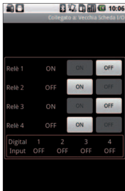
Fig. 4 – La ventana resume el estado de las entradas y los relés.
