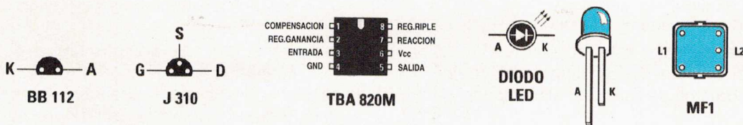
Fig.3 Conexiones de los terminales del diodo varicap BB.112, del fet J,310 y de la MF1 vistas desde abajo. Las conexiones del integrado TBA.820/M se ven desde arriba. Recordad que el terminal más largo del diodo DL1 es el A y el más corto el K.
