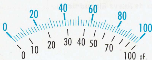
Fig. 1 Conectando a las dos bornas CAPACIDAD un tester analógico o digital situado en la escala 100 - 200 ó 300 microamperios fondo de escala, podréis leer directamente el valor en «picofaradios» de cualquier diodo varicap . Como la escala no es lineal, mostramos el valor correspondiente en picofaradios en función del valor en microamperios que leerá el tester.
