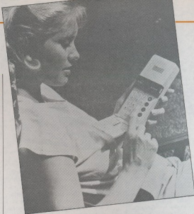
O telefone sem fio recebe e faz chamadas a até 200 metros do aparelho principal.
