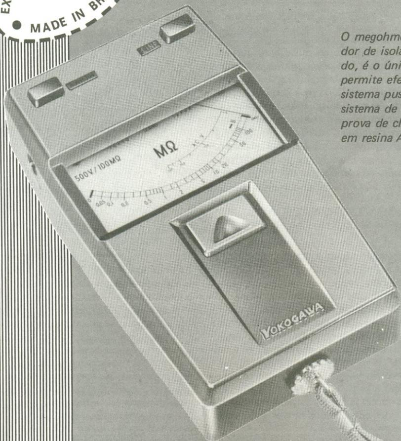
O megohmetro transistorizado tipo 3213 é um medidor de isolamento com circuito totalmente transistorizado, é o único que utiliza conversor cc-cc. O mesmo permite efetuar medidas rápidas e precisas através de sistema push-button de fácil operação. Graças ao seu sistema de suspensão "TAUT-BAND" o indicador é a prova de choques e vibrações, sua caixa é construída em resina ABS, tornando-o robusto.
