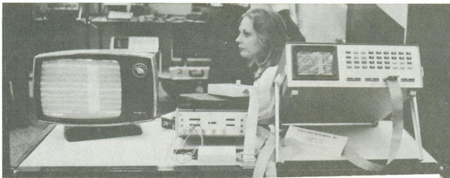
A Dolch apresentou seu Analisador Lógico, já bastante conhecido dos leitores da Nova Eletrônica. Este Analisador diagrama no tempo o nível de 16 pontos diferentes, simultaneamente.
