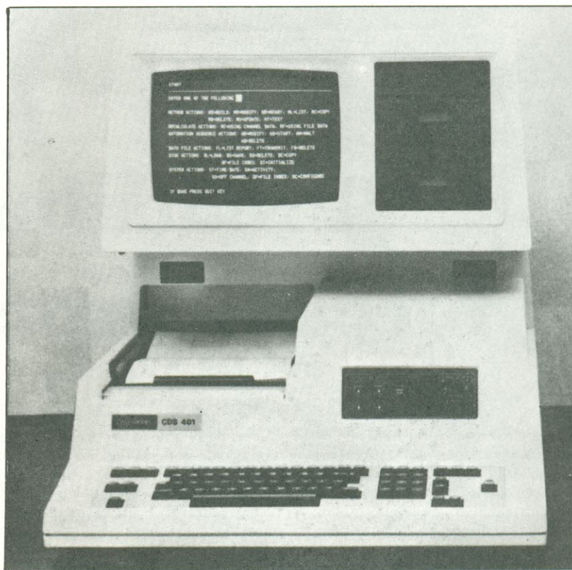
Um dos produtos expostos pela Varian é o Processador Vista 401, um computador de pequeno porte com registrador gráfico, usado para controle de processos.
