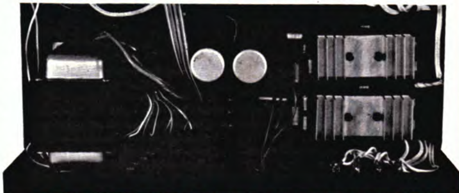
A ilustração nos mostra a placa B, depois de montados os componentes na mesma, e já colocada no fundo da caixa.
