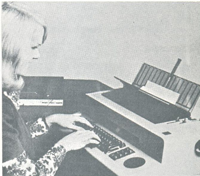
Modelos do produtor n.º 1 — Duas importantes máquinas, produzidas pelo líder nesse setor (a IBM), são a Mag Card II (à esquerda), com uma memória de 8000 caracteres, e a Memory Type-writer (acima) uma máquina de mesa com 4 k de memória.
