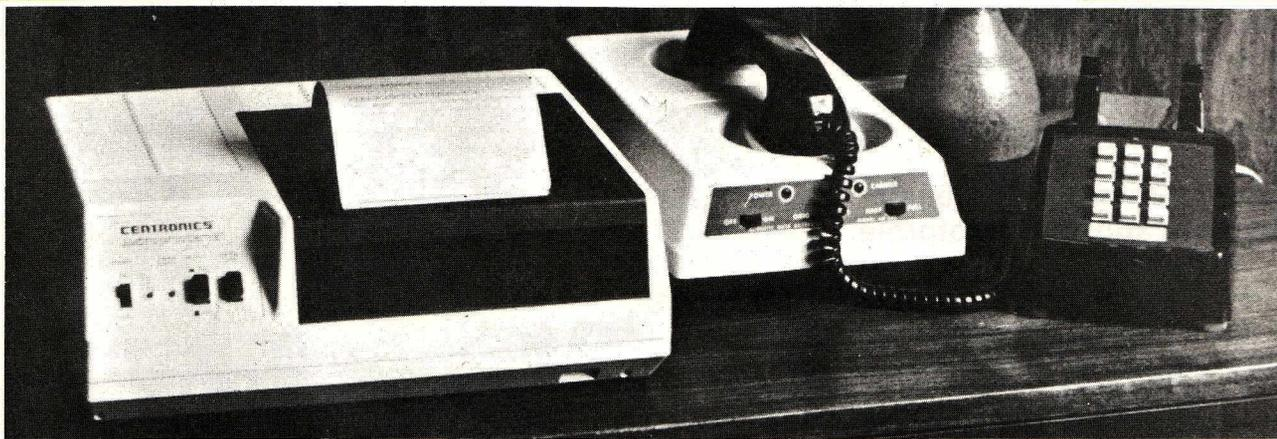
A Centronics Data Computer Corp. (NYSE), recentemente apresentou a Micro-impressora-S1 com **interface** em série, no Mini/Micro Show em Anaheim, Califórnia. A nova impressora, auxilia o usuário a selecionar ritmos de baud, paridade, e o número de bits de parada.
