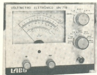
VOLTMETRO ELETRÔNICO A 92V/VA MOD - VAV-718 ( IMP. DE ENTRADA: 10M ) PREÇO CRS 3500,00
