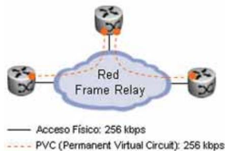
[fig.1] Enlace Frame Relay
