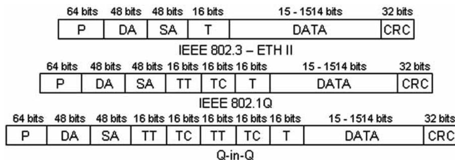
P=Preámbulo; DA=Dirección de Destino; SA=Dirección de Origen; TT=Tipo de Tag; TC=Tag de Control; T=Tipo de Protocolo encapsulado en DATA; DATA=Datos; CRC=Redundancia Cíclica
