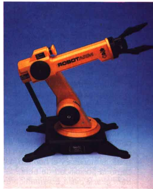
Foto 1. Detalle del Robot Arm de SpectraVideo. Cinco ejes permiten una movilidad absoluta.
