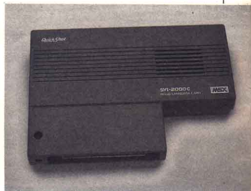
Foto 2. El cartucho esconde un lenguaje de programación específico para controlar este robot; el ROGO.
