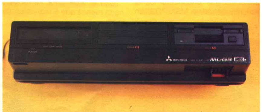
Foto 2. Vista anterior de la unidad central con unidad de disco, carcasa para disco adicional, interruptor de conexión y reset, y bus de expansión.
