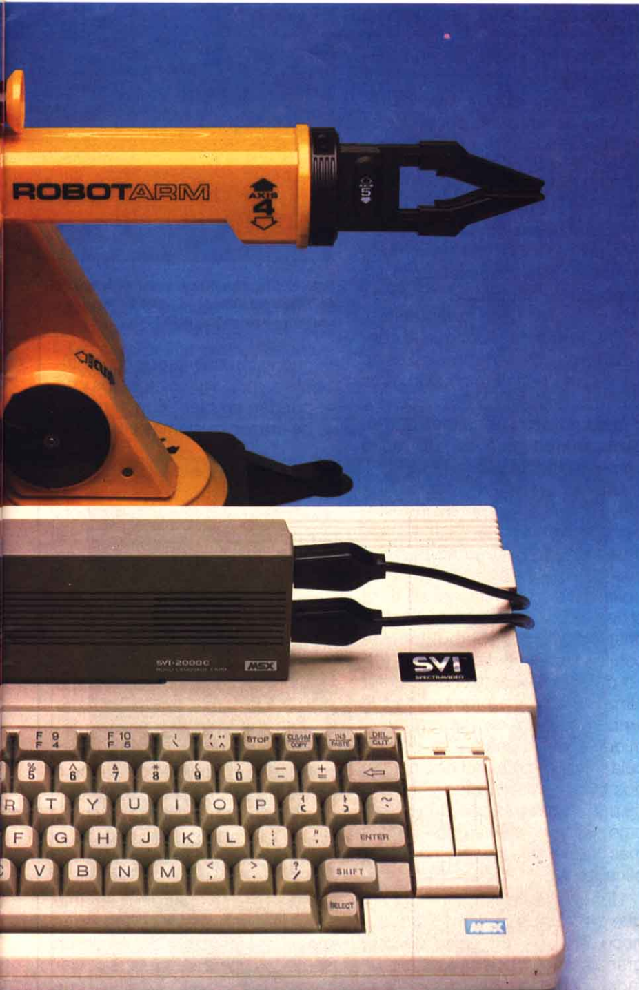
Foto 1. Detalle del Robot Arm de SpectraVideo. Cinco ejes permiten una movilidad absoluta.
