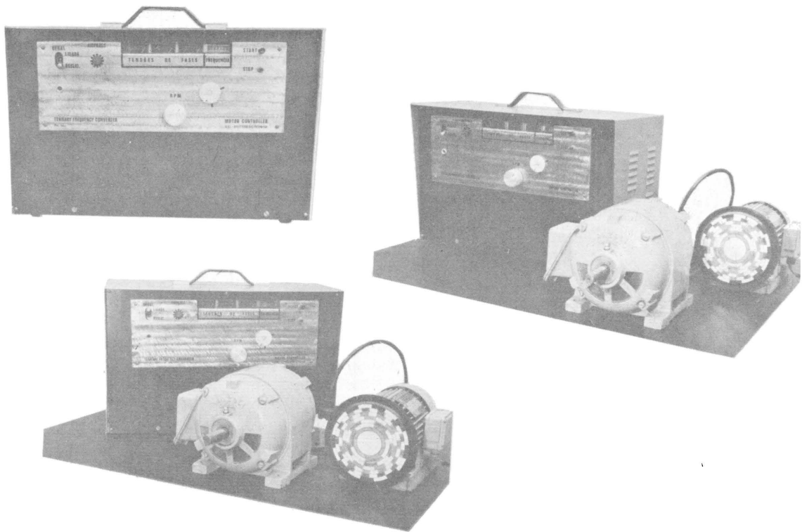
Em cima à esquerda: Aspecto do conversor de frequência para a variação e controle da rotação de motores elétricos trifásicos. Regula-se a velocidade desejada do motor por meio do botão marcado com "r.p.m.". O medidor à direita indica as rotações por minuto do motor; os três voltímetros mostram as tensões das fases. A direita e em baixo à esquerda: Alimentação simultânea de dois motores trifásicos pelo conversor de frequência. O maior motor é de 4 pólos, o menor de 6 pólos, sendo este último munido de um disco estroboscópico para visualização da sua velocidade de rotação.
