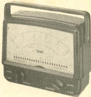
O microamperímetro é de precisão e totalmente blindado contra campos magnéticos externos. Sensibilidade 100.000 ohms p/V CC. 5.000 ohms p/V CA. Proteção automática contra sobrecargas.
