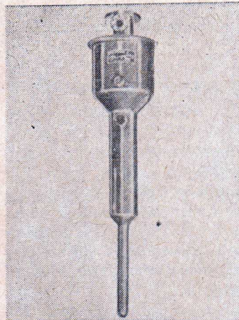
Garrafa térmica de aço inoxidável que contém circuito de memória de computador e o mantém a -268^{\circ}\text{C} .
