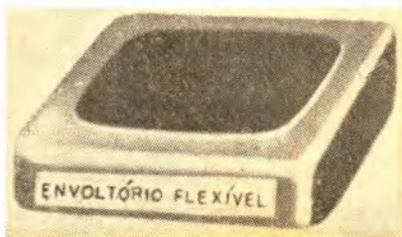
3 — Um envoltório elástico recobre a periferia de cada unidade, encerrando-a de forma a impedir as perdas de massa e infiltração do eletrólito entre as diferentes pilhas. Em virtude de sua elasticidade, esse envoltório acomoda as necessárias expansões de volume.
