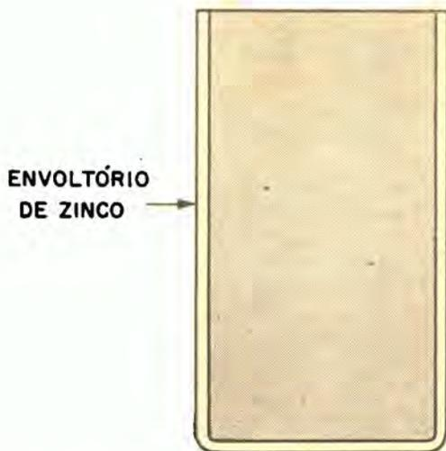
O recipiente é um cilindro de zinco, o qual além de acondicionar os constituintes da pilha, é, ainda, um elemento vital na produção de eletricidade.
