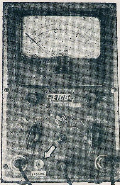
Jaque para medição de fuga instalado no VAV do autor, permitindo verificar condensadores no próprio circuito e fora dele.
