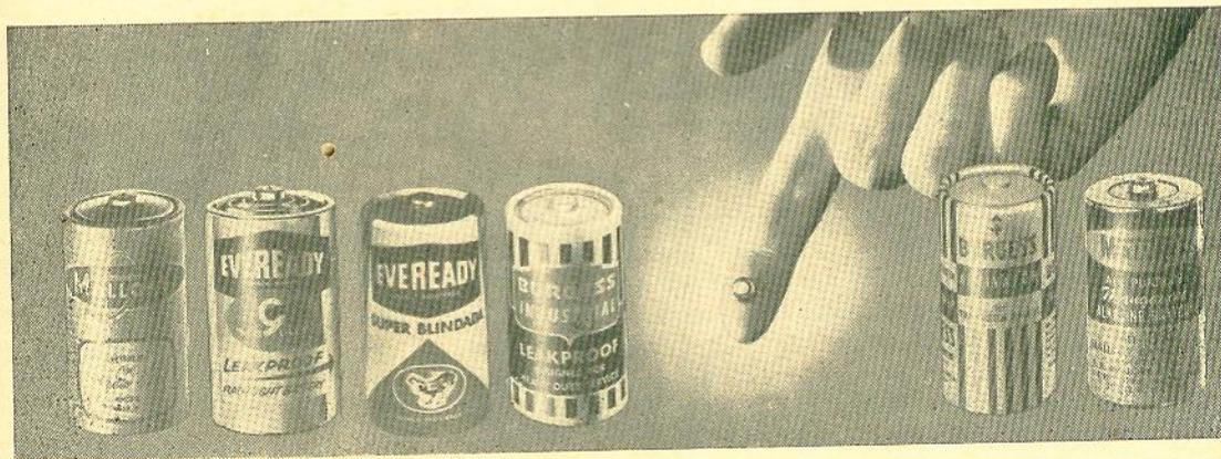
Na aparência as pilhas secas são todas parecidas, mas internamente bastante diferentes. Da esquerda para a direita vemos: D para rádios, lanternas, flashes, cargas severas, rádios transistorizados e uma bateria para aplicações variadas (manganês). No centro, é claro, está a familiar pilha de mercúrio usada para aparelhos para surdez ou micro-receptor.
