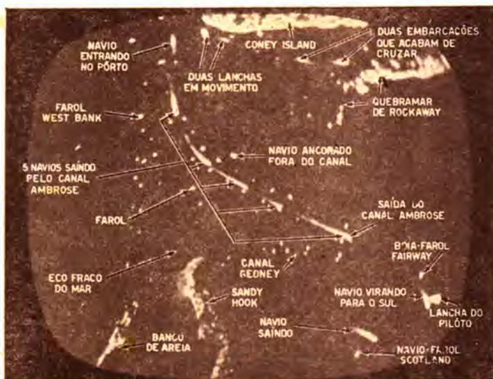
Esta é a imagem que aparece na tela do receptor sintonizado para o canal 47. A área ilustrada fica à saída do porto de Nova Iorque.
