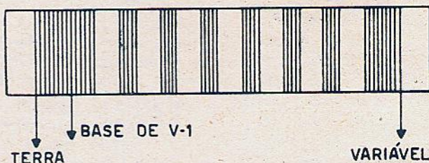
Fig. 4 — Identificação dos terminais da bobina de antena ferrite.
