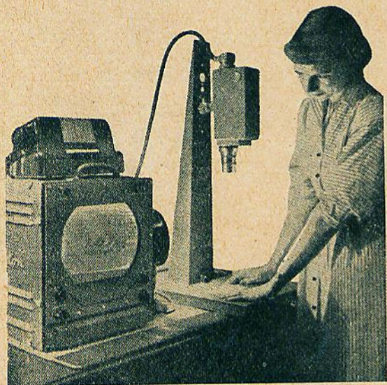
Empregados de bancos usam o sistema RCA de Televisão Industrial para comparação de assinaturas em cheques e outros documentos.
