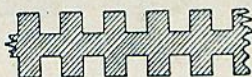
Fig. 4 — Armadura corrugada mecanicamente para aumento da superfície. Nos modernos condensadores o corrugamento é feito quimicamente.
