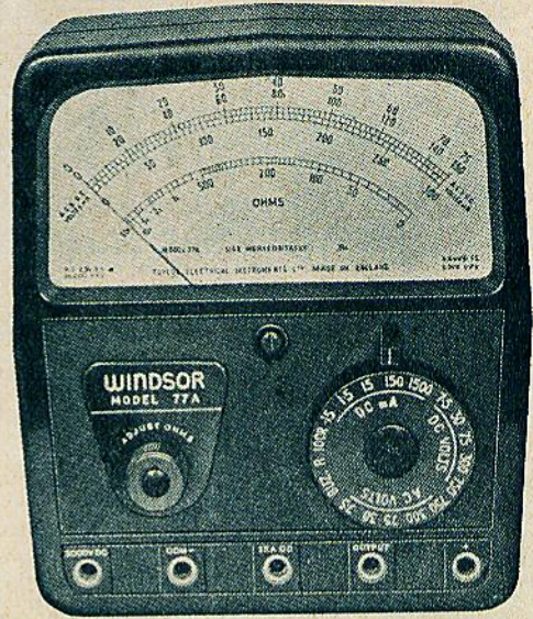
Modelo 77A — Multítester 20 000 ohms por Volt.
