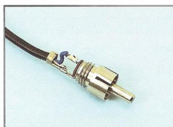
**6** O condutor interior do fio é soldado ao conector interior do conector. Não se deve aplicar calor excessivo pois algumas peças do conector podem se fundir.
