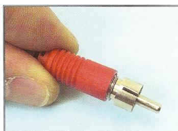
**7** A tampa do conector deve ficar bem ajustada e é preciso procurar escolher modelos que prenam bem o fio e que evitem uma flexão excessiva do mesmo.
