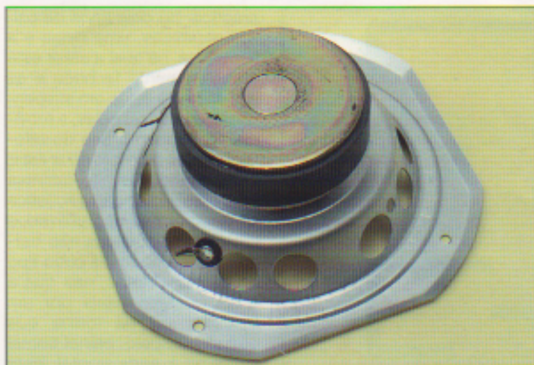
O ímã vai preso à carcaça, em alguns casos poderá estar coberto. Os terminais de conexão são fixados na carcaça.
