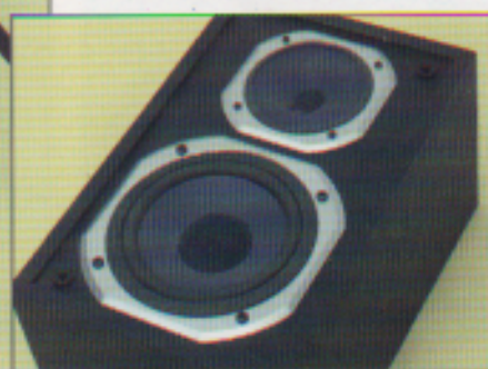
Para a reprodução de notas graves se necessita uma caixa acústica adequada ao alto-falante utilizado.
