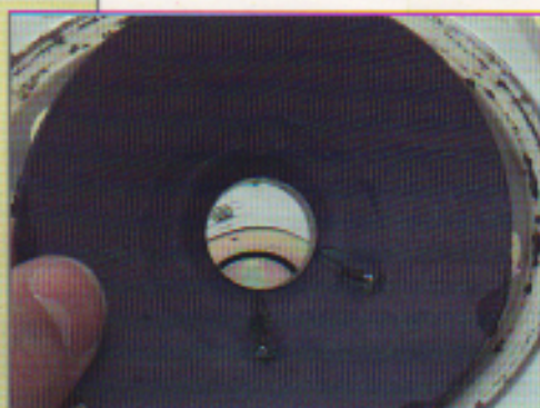
O deslocamento do cone do alto-falante é o que gera as ondas sonoras.
