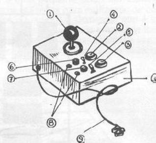
Alanca de Controle 2-Botão de Disparo nº 1 3-Botão de Disparo nº 2 4-Chave para Desativar o tiro automático 5-Chave para Ativar/Desativar o Tiro Automático 6-Controlador de velocidade do tiro 7-Controlador de velocidade do tiro 8-Led's indicadores da velocidade dos tiros 9-Flat Cable para conectar ao micro 10-Caixa Protetora em Fórmica.
