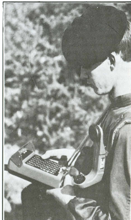
Soldado francês utilizando um terminal Thompson - CSF modelo TRC-743 para transmissão digital de mensagens.
