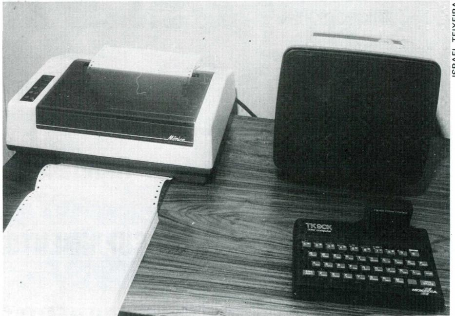
Com pequenas dimensões, a Parallel Printer Interface permite ao usuário conectar seu TK 90X a qualquer impressora paralela.
