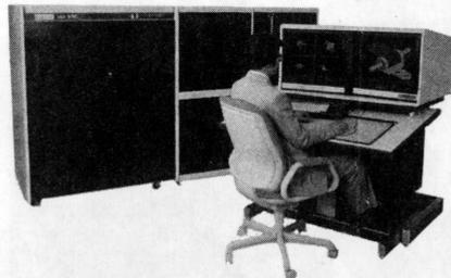
Terminal gráfico (Work Station) com a unidade de processamento VAX 11/780
