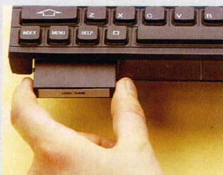
Los cartuchos de RAM, ROM o EPROM, se insertan en unos minizócalos polivalentes.
