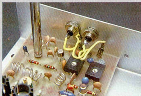
Detalle de las entradas de video y audio mediante sendos BNC. La antena a la izquierda se fija a la propia tarjeta. En primer plano el detalle de las bobinas.
