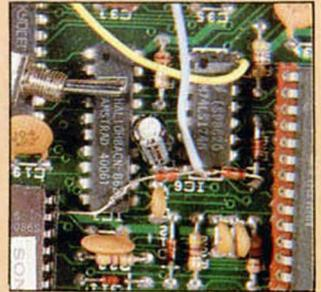
Detalle de la colocación de los diodos y el corte de la pista por el lado de componentes.
