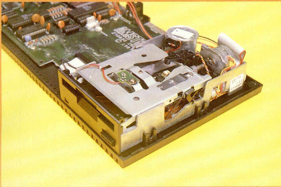
Vista interna del Plus 3 en la que se aprecia en primer término la unidad de disco.
