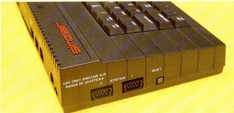
Vista lateral del nuevo modelo de SINCLAIR. Podemos observar las tomas para joystick y el botón de reset.
