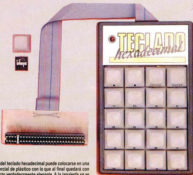
La tarjeta del teclado hexadecimal puede colocarse en una caja comercial de plástico con lo que al final quedará con este aspecto verdaderamente elegante. A la izquierda se ve una tecla desmontada de las que componen el teclado.
