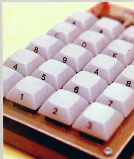
una cinta de diecisiete conductores que acaba en un conector hembra para introducir en el slot trasero del Spectrum. El circuito eléctrico utiliza el mismo puerto que el teclado del ordenador, esta es la razón por la que ambos funcionan en paralelo indistintamente. Por supuesto, este teclado hexadecimal sirve para cualquiera de los modelos de Spectrum (48 K, 128 Plus, Plus-2 y futuros).
