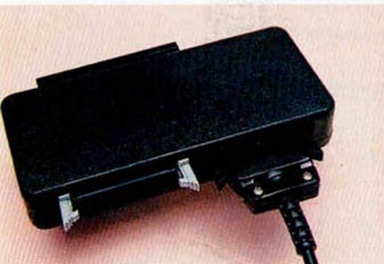
Además de las funciones típicas de cualquier ratón, el «AMX mouse» incorpora un interface de impresora que permite hacer COPYS de pantalla con una resolución cuatro veces superior a la normal.
