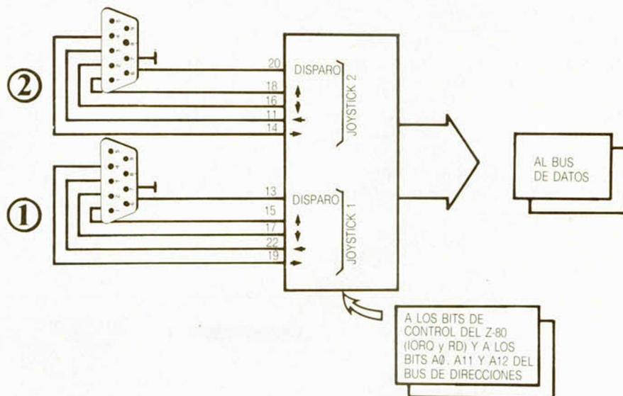
FIGURA 2. Conexión de los joysticks normalizada tipo Atari.
