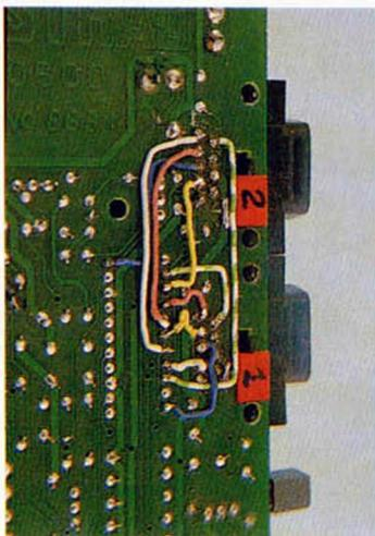
al corte, marcar con un rotulador el sitio exacto antes de cortar, a fin de efectuar un repaso de seguridad. En total hay que hacer doce cortes con la única precaución de no cortar pistas próximas o cualquier otro accidente.
