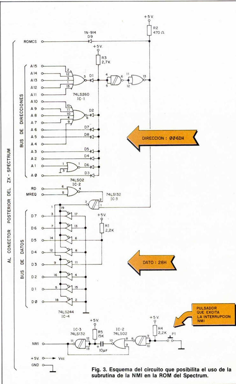
Fig. 3. Esquema del circuito que posibilita el uso de la subrutina de la NMI en la ROM del Spectrum.
