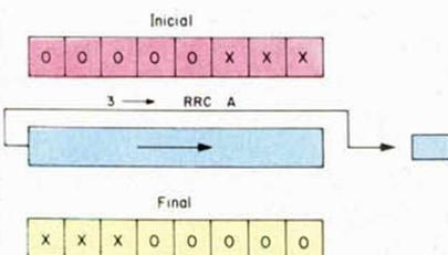
**Traslado de los tres bits menos significativos a la parte alta del byte, mediante la instrucción RRCA.**
