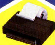
CENTRONICS «E» INTERFACE Para conectar tu impresora. No necesita Software. Reconoce LLIST, LPRINT y COPY
