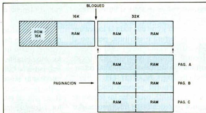
Figura 2: Bloqueo y paginación esquemáticos de los últimos 32 K bytes del Spectrum.
