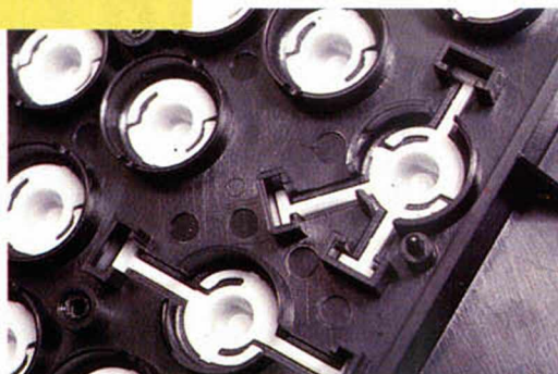
Detalle del mecanismo de pulsación.
