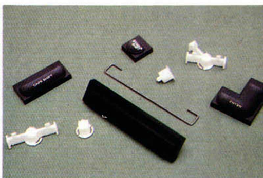
Despiece de los elementos que forman una tecla.
