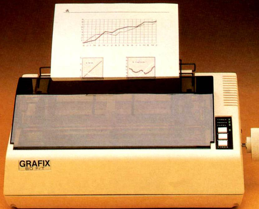
A GRAFIX 80 F/T é versátil. Com ela você pode facilmente imprimir formulários contínuos e folhas soltas como papéis de carta, envelopes, etiquetas, etc. Isto porque a GRAFIX 80 F/T é a única que vem equipada com trator e com cilindro de borracha, igual aos das máquinas de escrever, permitindo a impressão da primeira à última linha.
